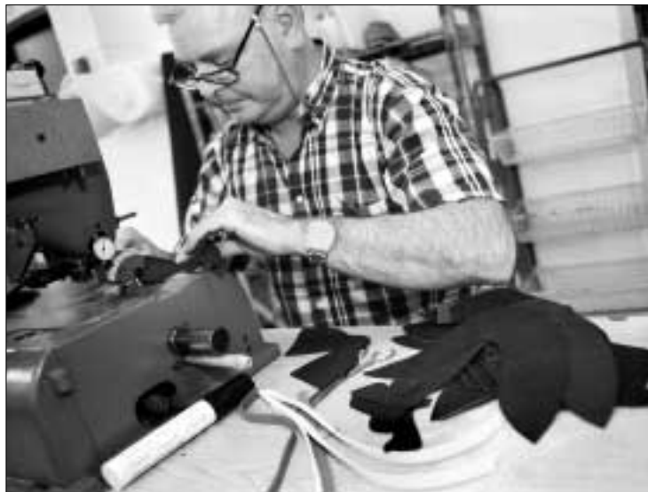
Det ligg lang trening og rutine bak når Roar Johnsrud drar skinnstykket gjennom skjeferingsmaskinen.
