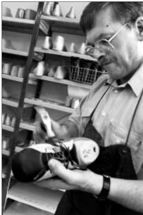
Pinning er faguttrykket. Ein og ein spikar må på plass før stiftmaskinen kan brukast. Etterpå må spikrane trekkjast ut.
